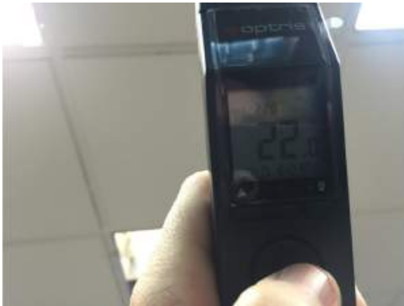
Habitación sin cubierta Cool-R: 22°
