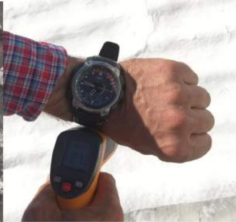
Cubierta con Cool-R 19 de mayo 18:46 - 27°
