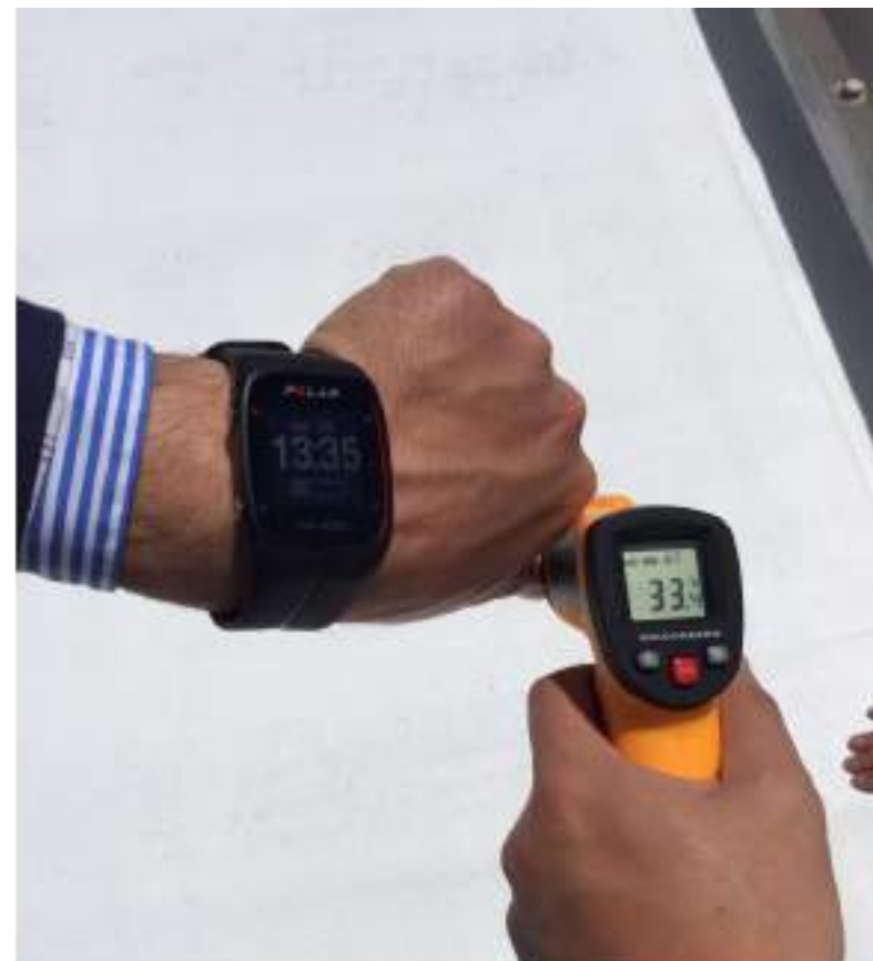
Cubierta con Cool-R 2 de junio 13:35 - 33°
