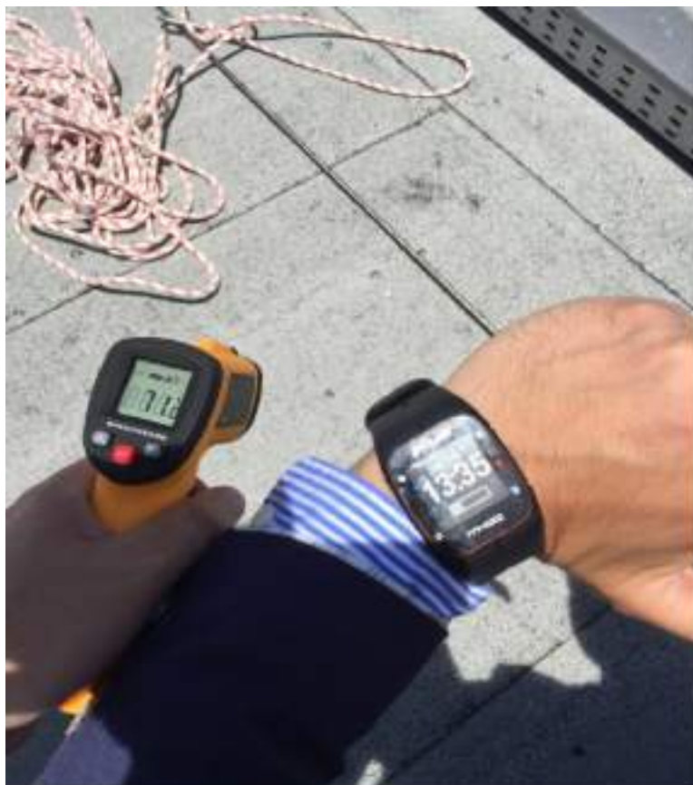
Cubierta sin Cool-R 2 de junio 13:35 - 71°
